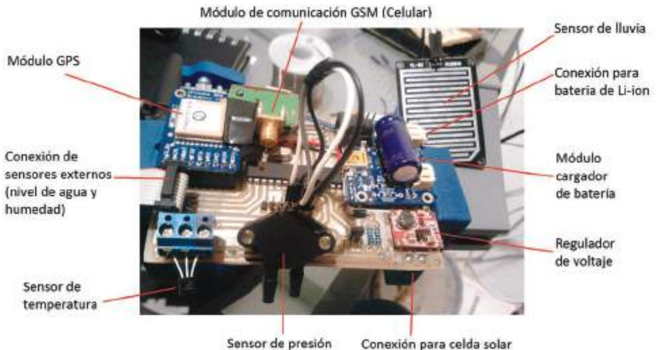
Figura 6. Prototipo antes de ensamblarse dentro de la caja protectora
