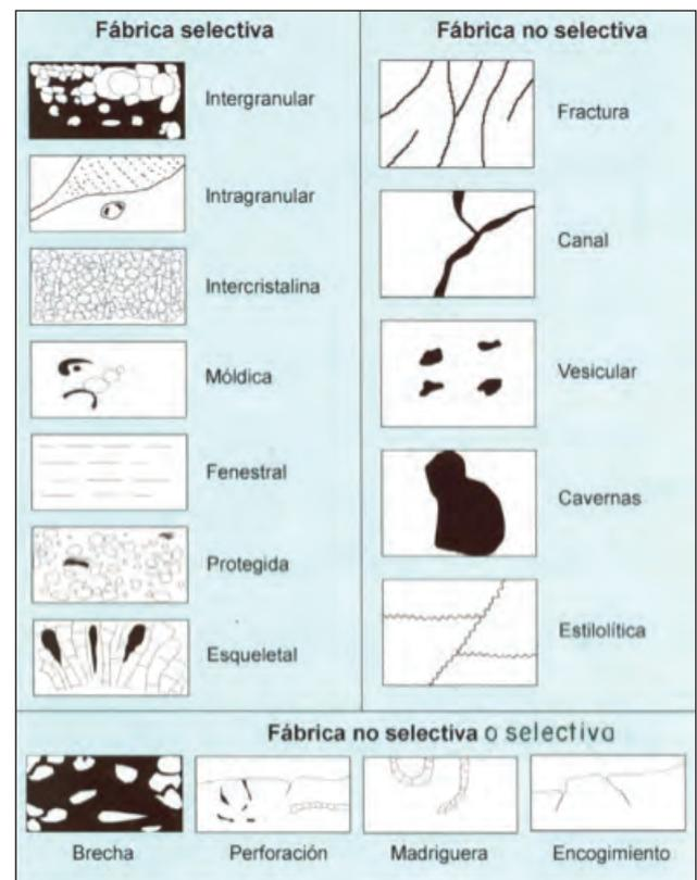
Imagen 2.- Clasificación y Tipos de Porosidad en rocas carbonatadas (Choquette y Pray, 1970)
