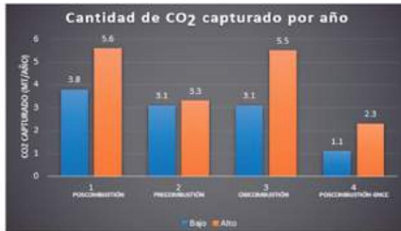
**Figura 2.** Comparación de las cantidades de CO<sub>2</sub> capturado por año (Mt/año) de las diferentes plantas donde se aplicaron tecnologías de almacenamiento de carbono. Fuente: Modificada de (Saldívar *et al.* 2017), basada en (Rubin, Davison y Herzog, 2015).
